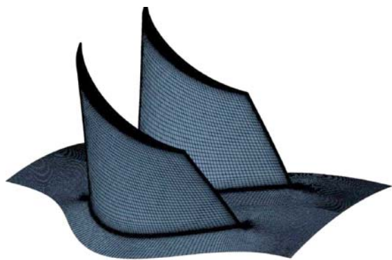
图 6 动叶壁面网格 Fig 6 Rotor solid mesh
