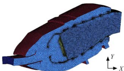
图 5 基于参数化建模自动生成的网格
