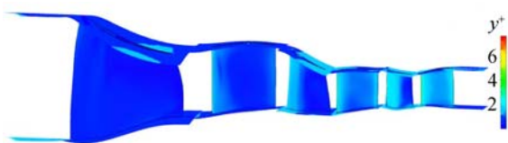
图 3 三维叶片几何造型及 y^+ 分布
