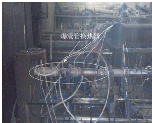
图 3 爆震管换热实验装置实物图
