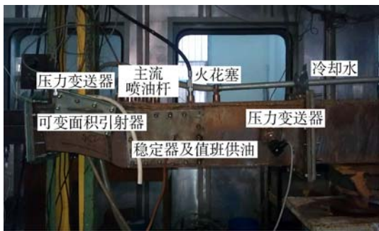
图 2 TBCC 超级燃烧室试验模型
