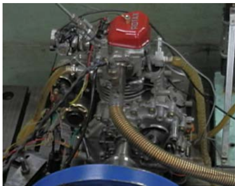
图 1 直喷单缸试验机
