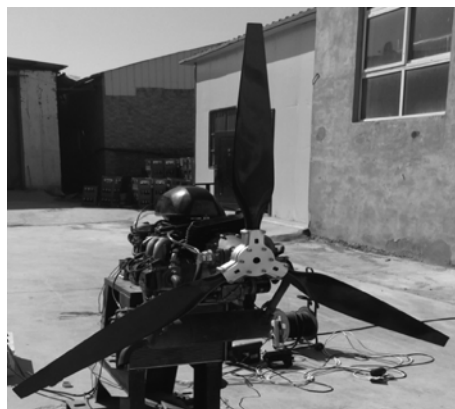
图 3 安装在试验台上的三叶复合材料螺旋桨
