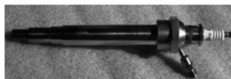
图4 适用于超声速燃烧室的火炬等离子体点火器 Fig. 4 Plasma torches used for supersonic chamber
