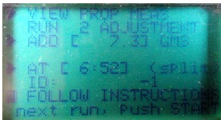
图6 某型振动值测试仪的配平方案
