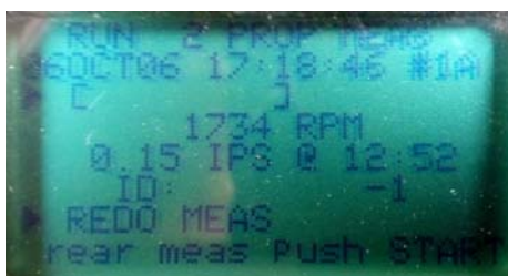
图 8 某型测试仪对振动的测量结果
