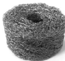
图6 圆环形金属丝网橡胶
