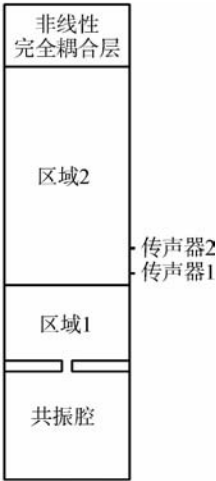
图 1 阻抗管与共振腔计算模型
