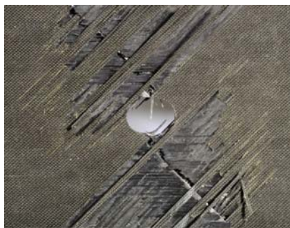
图 1 CCF300/QY8911 复合材料含孔层合板失效模式
