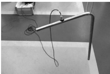
图 3 L 型空间管路固有频率测试系统
