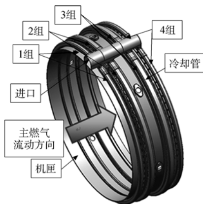
图 1 高压涡轮 ACC 系统设计方案示意图
