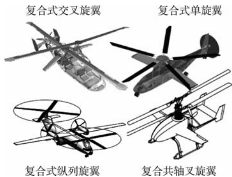
图 1 复合式直升机构型分类图
