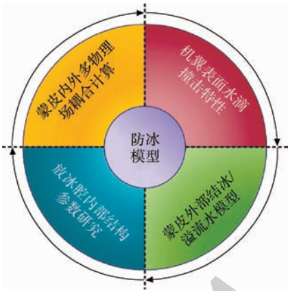
图 3 防冰系统主要模块示意图 Fig. 3 Sketch map of main modules of anti-icing system
