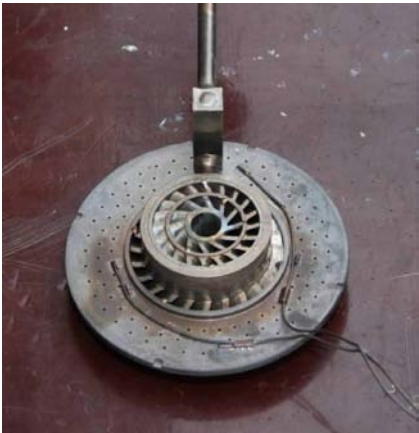
图 2 TAMDIM 高温升燃烧室头部照片 Fig. 2 Photo of TAMDIM high-temperature rise combustor dome
