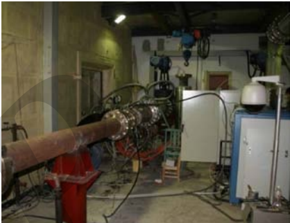
图 3 高温高压燃烧室试验设备 Fig. 3 High-temperature and high-pressure combustor test rig
