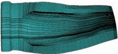
图 3 空心风扇叶片有限元模型 Fig. 3 Finite element model of the hollow fan blade
