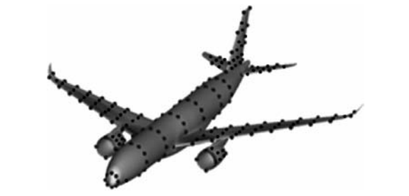
图 9 用于插值的结构节点在物面上的分布
