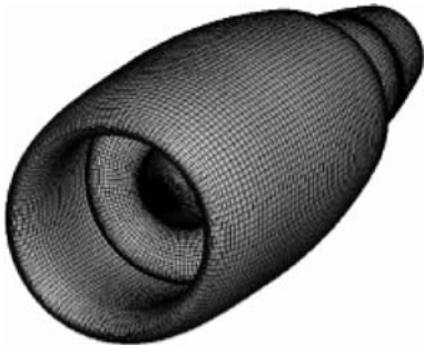
图 4 TPS 模型表面网格分布
