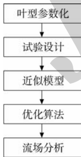
图 9 叶型的优化流程 Fig. 9 Airfoil optimization process
