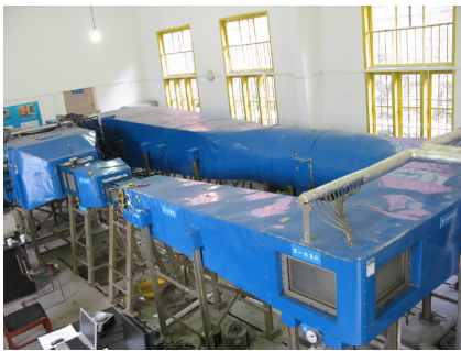
图 1 0.3 m×0.2 m 结冰风洞
