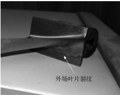
图 1 外场故障叶片图
