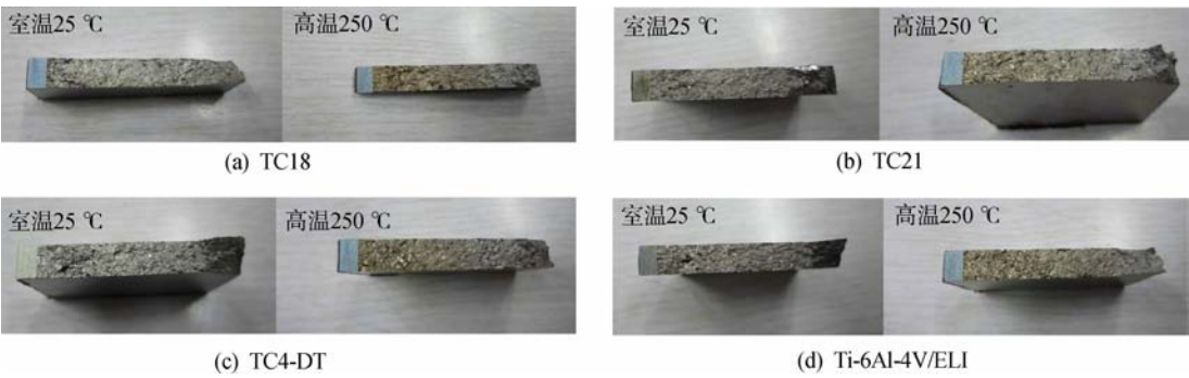
图 4 钛合金裂纹扩展宏观断口
