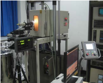
(a) 裂纹扩展试验系统
