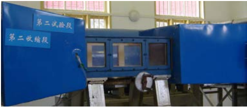
图 1 0.3\text{ m}\times0.2\text{ m} 结冰风洞第二实验段 Fig. 1 Secondary test section of 0.3\text{ m}\times0.2\text{ m} icing wind tunnel
