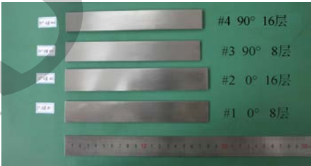
图 7 SiC/TC4 复合材料薄板试验件 Fig. 7 Test piece of SiC/TC4 composite plate
