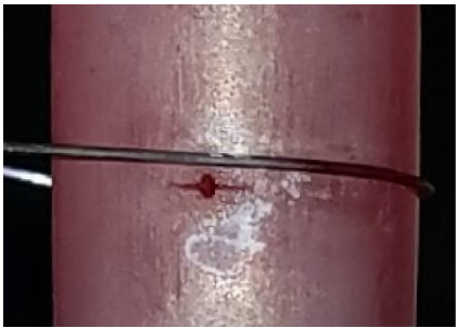
图 5 裂纹扩展宏观照片
