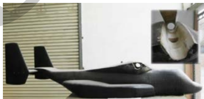
图 2 模型机身及 T 型支架系统的安装槽
