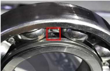
图 12 内滚道存在初始剥落的轴承
