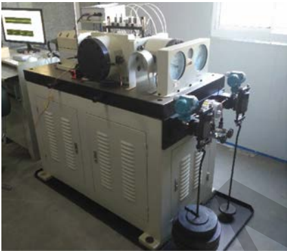
图 10 ABLT-1A 轴承强化试验机
