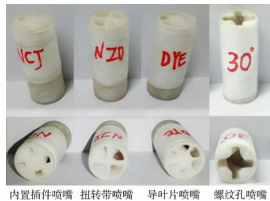
图 5 3D 打印的旋流喷嘴实物 Fig. 5 Swirl nozzle by 3D print
