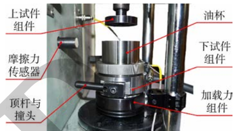
图 1 试验机工作台结构图
