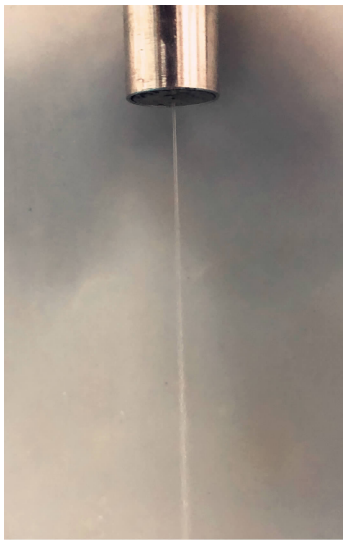
图 10 直射式喷嘴在 2 MPa 下的雾化效果图 Fig. 10 Atomization effect of direct jet nozzle with 2 MPa pressure
