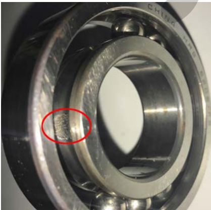
图 21 轴承 2 剥落图 Fig. 21 Bearing 2 spalling picture
