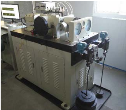
图 16 ABLT-1A 轴承疲劳强化试验机
