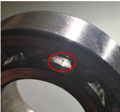
图 22 轴承 3 剥落图 Fig. 22 Bearing 3 spalling picture
