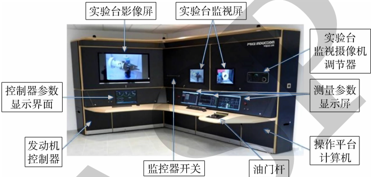
图 2 DGEN380 发动机操作台 Fig. 2 General view of the DGEN380 control desktop
