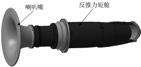
图 5 喇叭嘴安装示意图 Fig. 5 Installation diagram of bell mouth
