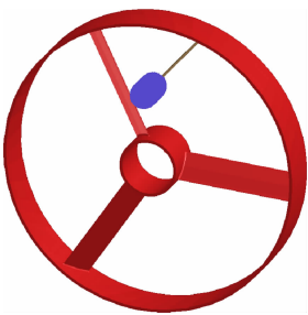
图 13 模拟试验件鸟撞击仿真分析模型 Fig. 13 Bird impact simulation analysis model for simulated test specimens
