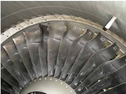
图 1 航空发动机鸟撞后典型损伤
