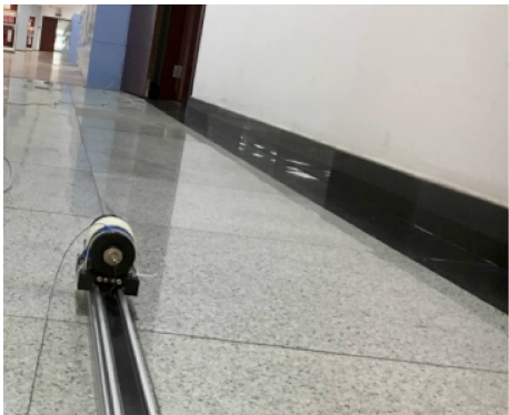
图 8 直线导轨测相对风速实验实物图
