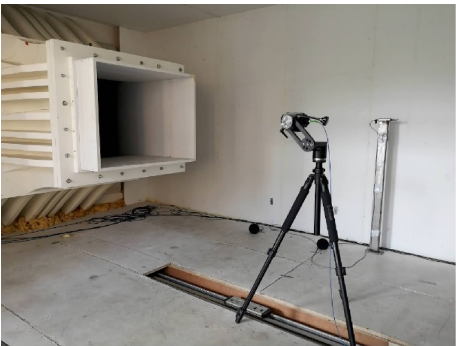
图 15 传感器在风洞实验中的实物图 Fig. 15 Image of sensor in wind tunnel experiment
