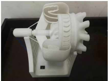
图 4 单一复合叶轮涡轮发动机模型 Fig. 4 A model of single composite impeller gas turbine
