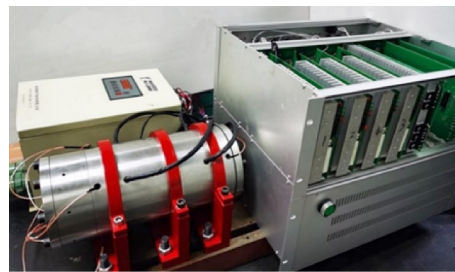
图 16 磁气组合轴承转子系统试验台
