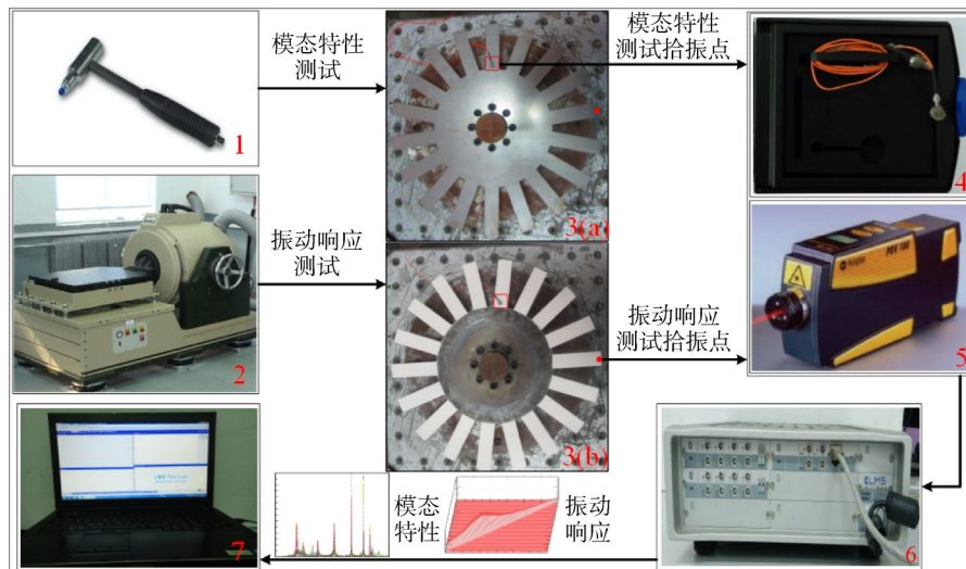
图 6 硬涂层整体叶盘振动实验设备及测试流程
