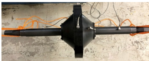
图 12 盘鼓转子螺栓连接结构固有频率测试系统
