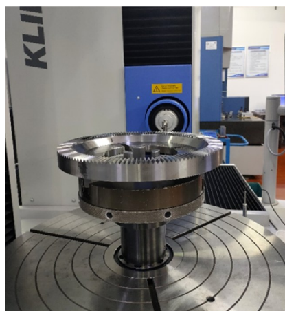
图12 克林贝格齿轮测量中心测量面齿轮
