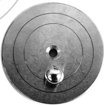
图 1 无磁合金 GH05 球盘试样
