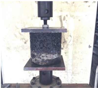
图7 拉拔试验中的试件安装
