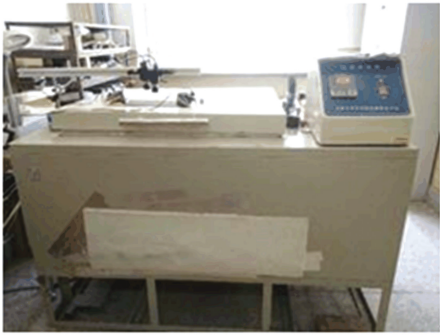
图 11 低温收缩线系数的测定设备
