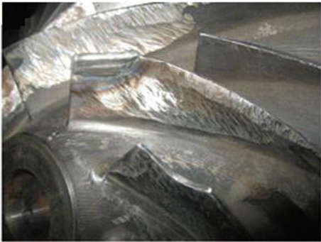
(b) 叶片(2)成形后整体形貌
