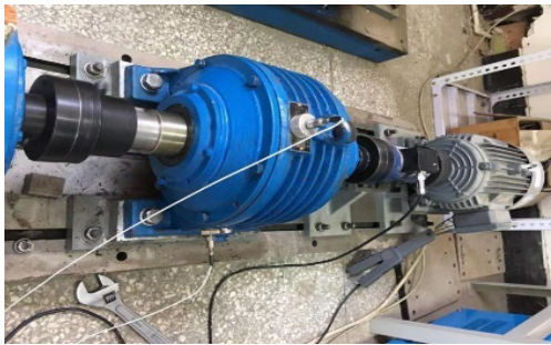
图 4 行星齿轮轴承实验装置 Fig. 4 Planet gear bearing experimental rig
