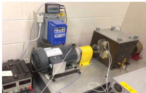
图 5 变速箱运行状态模拟实验装置
