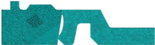
图 4 梁式管接头有限元网格模型 Fig. 4 Finite element mesh model of beam seal
