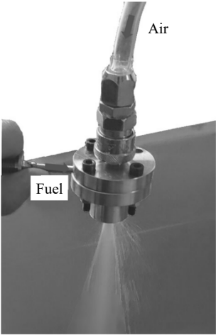
图 7 油雾锥角试验 Fig. 7 Spray cone angle test
