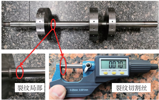
图 3 裂纹转子示意图 Fig. 3 Schematic diagram of cracked rotor
