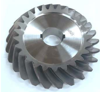
图 1 试验测试的螺旋锥齿轮 Fig. 1 Spiral bevel gear for experiment test
