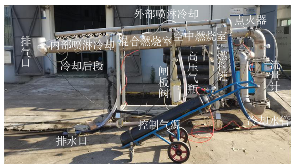
图 4 混合燃烧系统实物装置
